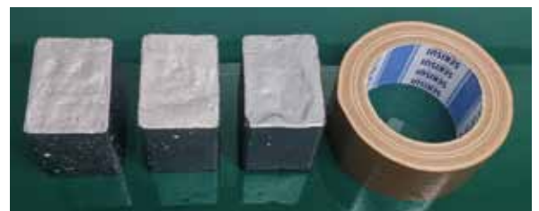
ガムテープによる付着力試験
