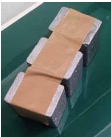
ガムテープによる付着力試験
