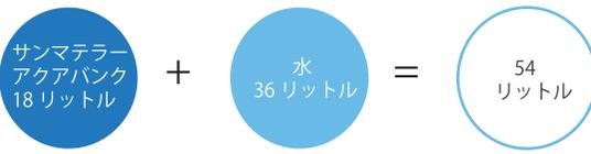
平均塗布量 200 cc / m<sup>2</sup> (1回散布) 1缶あたりの使用量 270 m<sup>2</sup> / 18L 缶
