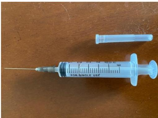
写真のようにシリンジを使うと効率良くひび割れ部からサンマテラーアクアを注入可能です。シリンジは通販サイトで入手出来ます。
