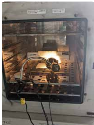
防汚剤の塗布と未塗布。UV-C 照射と同時に熱源ランプ（100℃）を試験体に照射。
