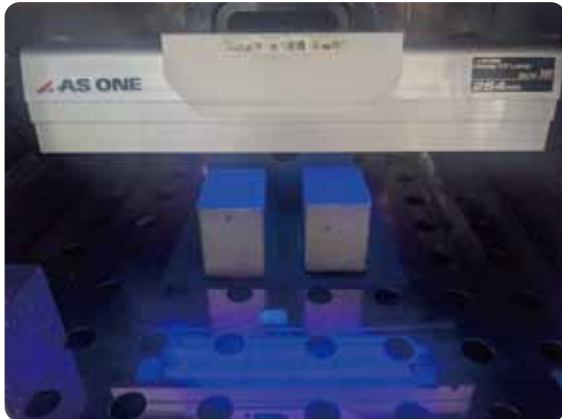
サンマテラークラウドウォールと PTFE コート材に UV-C ランプを照射中の様子
