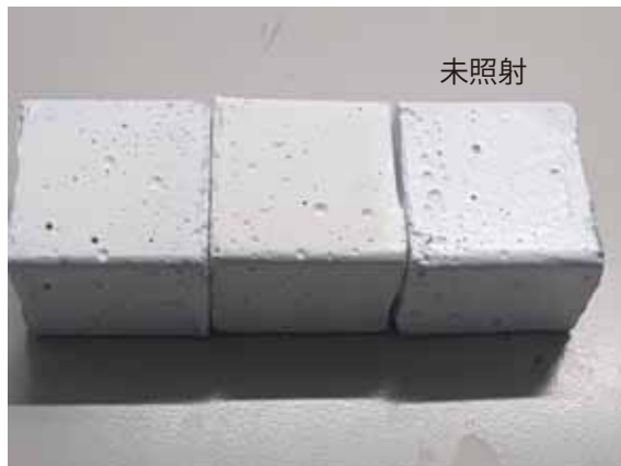
UV-C 試験照射後の様子。右側の試験体は照射していませんが照射された真ん中と左側の試験体と比較した場合、黄変、艶消滅が認められる。
