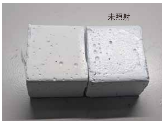
UV-C 試験照射後の様子。右側の試験体は照射していませんが照射された真ん中と左側の試験体と比較した場合、黄変、艶消滅が認められる。
