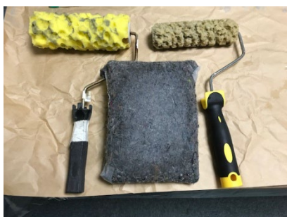
打放し風パターン付け工具 界面ローラー、砂骨ローラー、フェルト材
